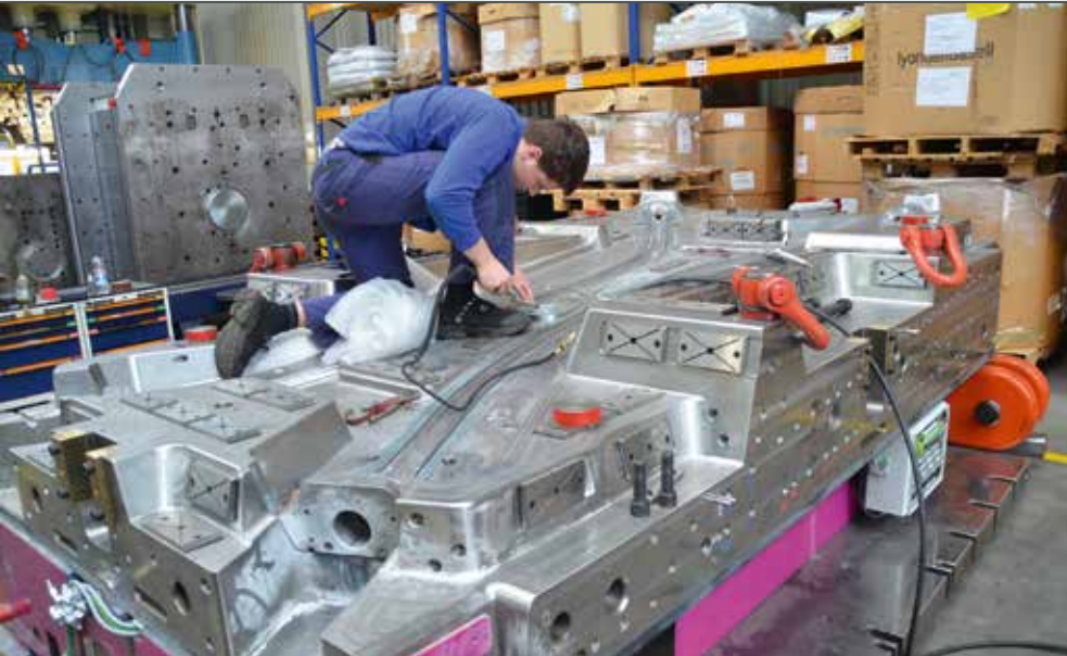
Finishing einer CFK-Form: Die Oberfläche dieses Dachrahmens bekommt den letzten Schliff. In CFK-Formen ist deutlich mehr Sensorik untergebracht als in Kunststoffspritzgießwerkzeugen. (Bild: Schröder)
